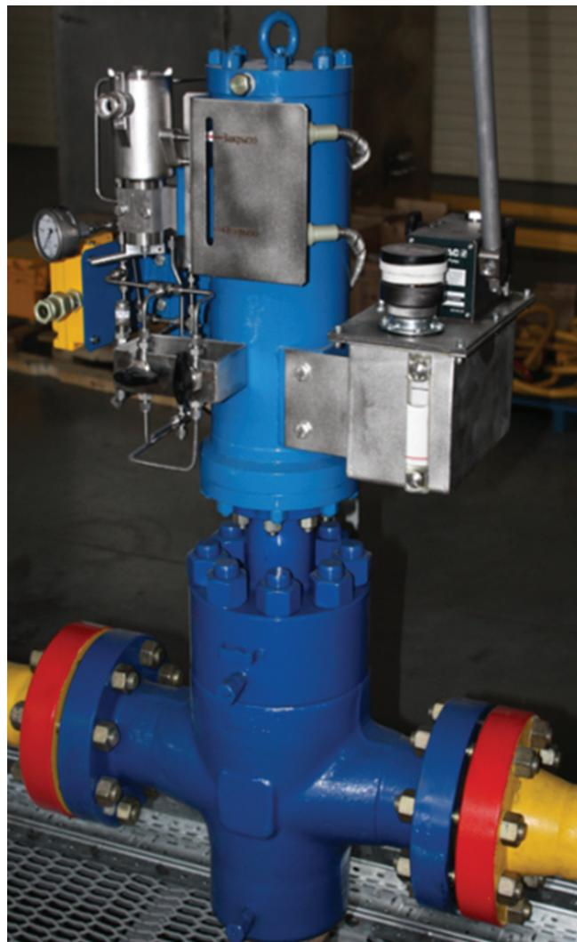
рабочей жидкости насосом в полость гидропривода, закрытие - с помощью пружины гидропривода.
