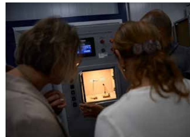
Испытания УЗИП в тестере тепловой стабильности УЗИП АТ2188-003-G
