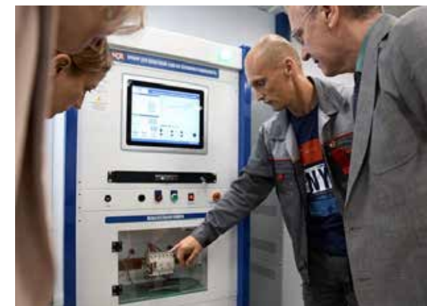
Испытания УЗИП 3 класса в генераторе комбинированной волны ГКВ-25000
