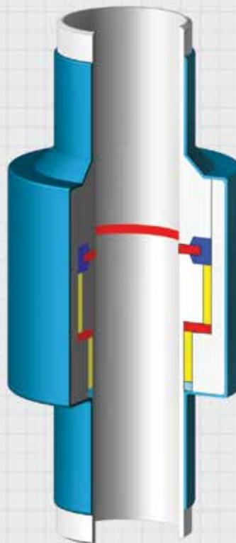
5 Применение двух торцевых кольцевых диэлектрических колец (на рисунке выделены красным цветом) обеспечивает прочность соединения при воздействии как сжимающих, так растягивающих нагрузок, возникающих в трубопроводе в процессе эксплуатации
