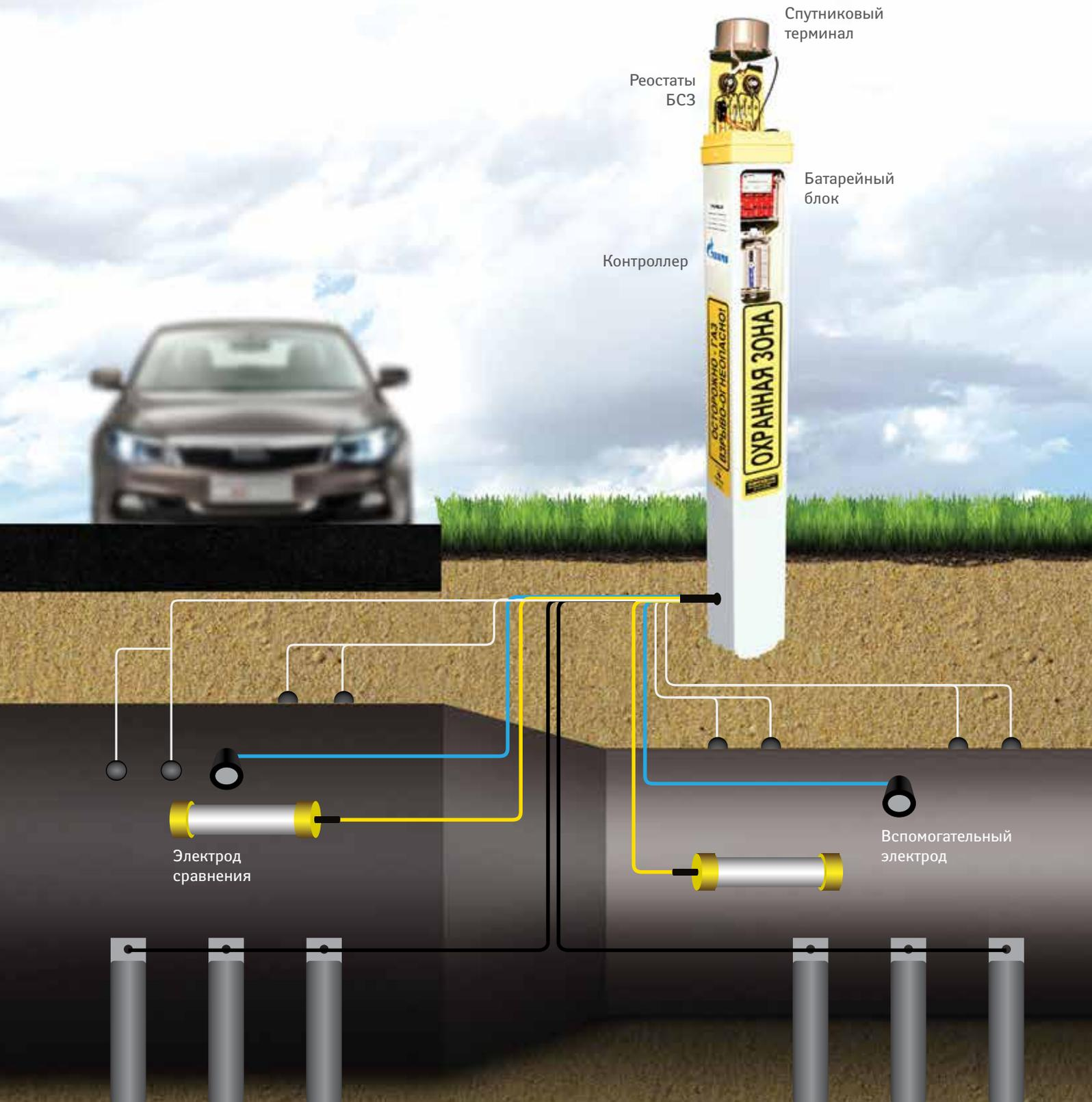
ПКМ-ТСТ-КИП – подсистема коррозионного мониторинга, обеспечивающая мониторинг параметров ЭХЗ на контрольно-измерительных пунктах, расположенных в различных зонах ПКО и на конструктивных элементах защищаемого объекта.
