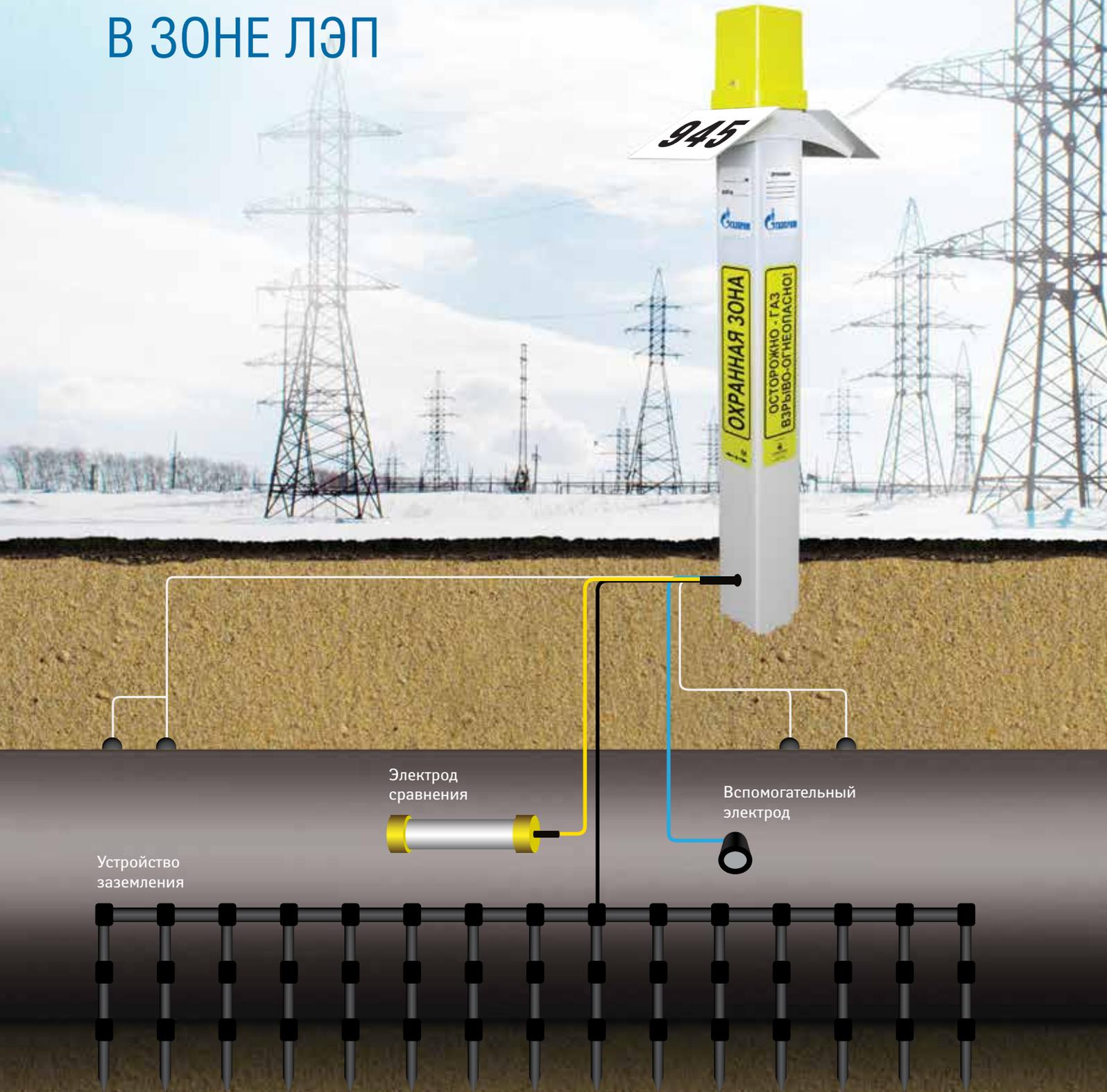
ПКМ-ТСТ-УЗТ – подсистема коррозионного мониторинга, которая представляет собой блок отведения наведенных на трубопровод переменного и постоянного токов, оснащенный контроллером и каналом передачи данных. Постоянный ток отводится при условии выхода напряжения на трубопроводе за пределы заданного диапазона.
