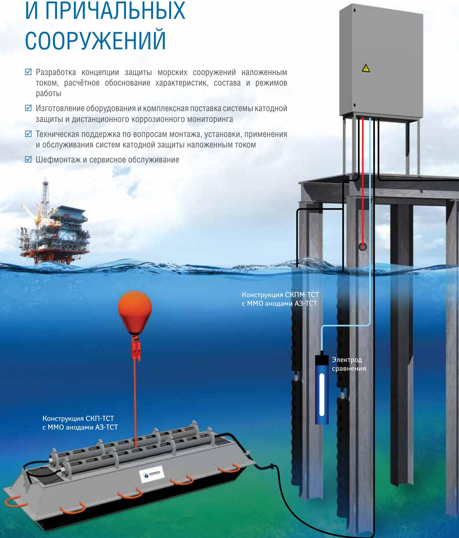
Конструкция СКПМ-ТСТ с MMO анодами АЗ-ТСТ
