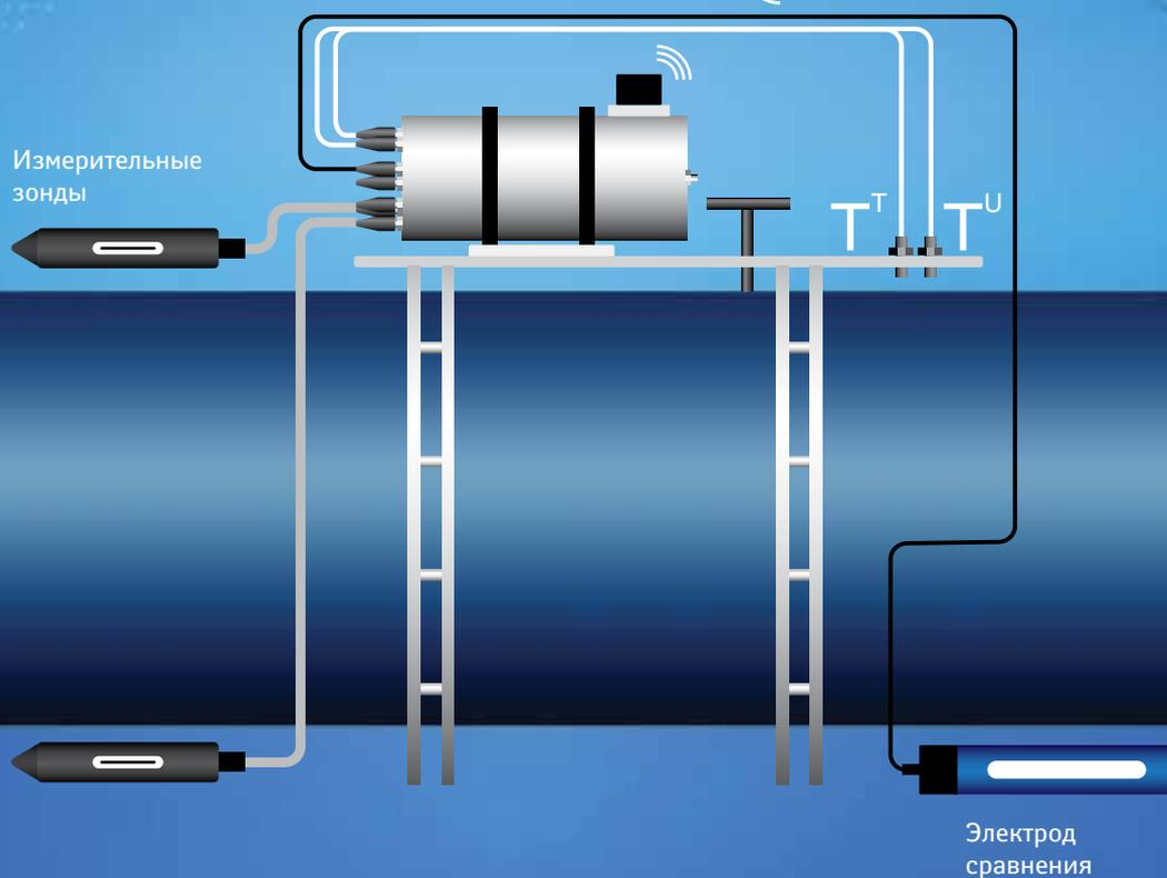
Подсистема коррозионного мониторинга ПКМ-ТСТ-КонтКорр®-М (совместная разработка ЗАО «Трубопроводные системы и технологии» с ООО «Газпром ВНИИГАЗ» и ЗАО «КАТОДЪ») предназначена для удаленного мониторинга параметров коррозионной ситуации на подводных стальных трубопроводах по беспроводным каналам связи (гидроакустическому и GSM).
