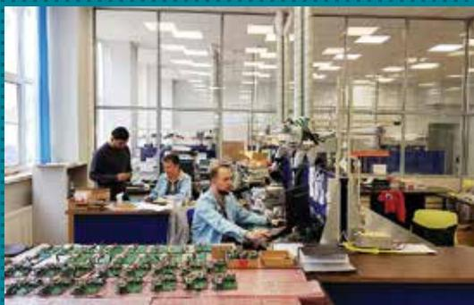
Входной контроль измерительных модулей ПКМ
