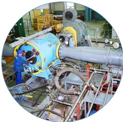
Стенд для исследования процессов в модельных ступенях центробежных компрессоров
