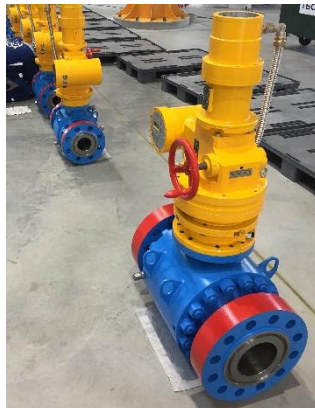
Шаровые краны DN50-DN1000 «Металл-по-металлу»
