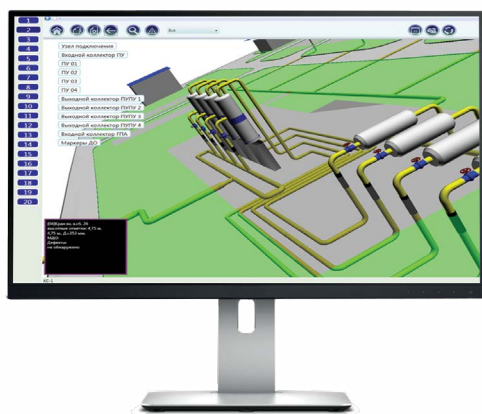
Пример 3d-модели (компрессорная станция в части «пылеуловителей»)
