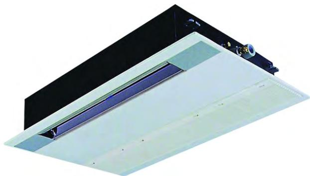
Угол поворота первой створки жалюзи составляет  $40^{\circ}\sim 42^{\circ}$ , второй створки  $37^{\circ}\sim 38^{\circ}$ . Такая конструкция обеспечивает наиболее равномерное распределение воздушного потока по помещению.
