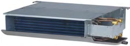
Фанкойл оснащен двумя независимыми теплообменниками воздухоохлаждателя и воздухонагревателя. Такое решение позволяет поддерживать индивидуальные параметры воздушной среды в различных зонах в зависимости от предпочтения каждого пользователя. Один из фанкойлов может работать в режиме охлаждения, в то время как другой – в режиме нагрева.
