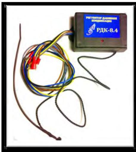
Регулятор давления компенсации РДК-8 (далее прибор), является микропроцессорной системой и предназначен для обеспечения работоспособности систем кондиционирования, работающих в режимах «охлаждение», либо «охлаждение-нагрев» номинальной мощностью до 14 кВт, при отрицательных значениях температуры окружающей среды, вплоть до  $-40\text{C}$ .
