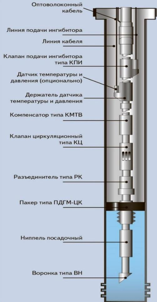
Опционально комплекс может быть оборудован системой для контроля скважинных параметров:
