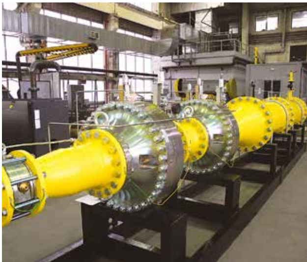
Технические решения на базе регуляторов давления МЕТРАН, собранные в технологическую линию редуцирования на опорной раме
