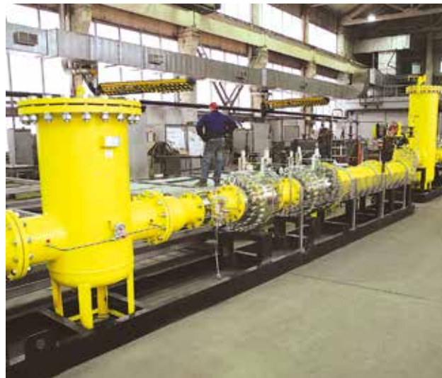
Технические решения на базе регуляторов давления МЕТРАН, собранные в технологическую линию редуцирования на опорной раме
