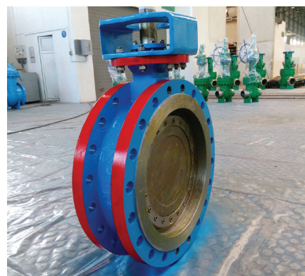
После нанесения покрытия
