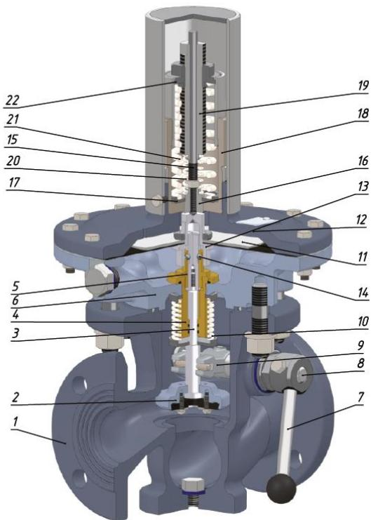
Клапан предохранительный запорный имеет фланцевый корпус вентильного типа 1. Внутри корпуса находится седло, которое перекрывается клапаном 2 с резиновым уплотнителем.
