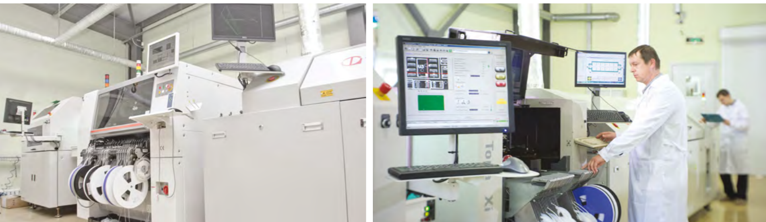
Цех SMT монтажа. Используются компоненты от ведущих мировых производителей. Максимальная производительность до 75 000 компонентов в час.
