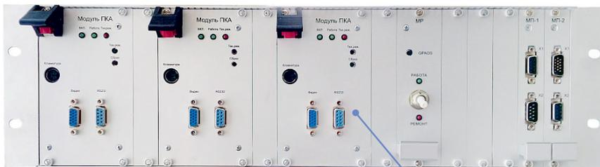
**Модуль ПКА (ПКА)** – промышленный компьютер агрегатной автоматики, процессор Vortex86DX с частотой 600 МГц, ОЗУ 256 Мбайт, 2xRS-232/422/485, 2xRS-232, 6xRS-422/485 (с гальванической развязкой), 2xCAN, LAN 10/100, LPT, 4xUSB2.0, 8xGPIO, 2xI2C, VGA. Отвечает за связь с модулями связи и с АРМ оператора, выполняет алгоритм управления.
