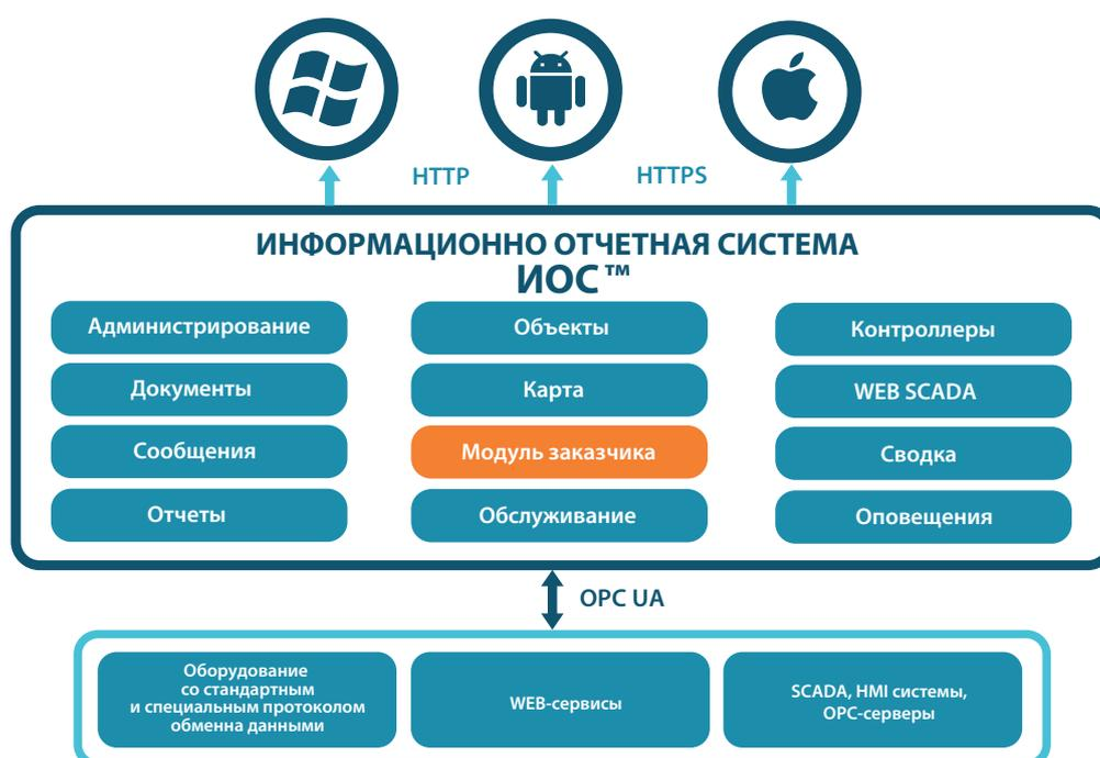
Заданная функциональность готового решения реализуется за счет создания т.н. **конфигурации** – т.е. комплекса настроек стандартных компонентов и добавления специализированных компонентов (программных модулей), выполняемых в соответствии с требованиями технического задания Заказчика.
