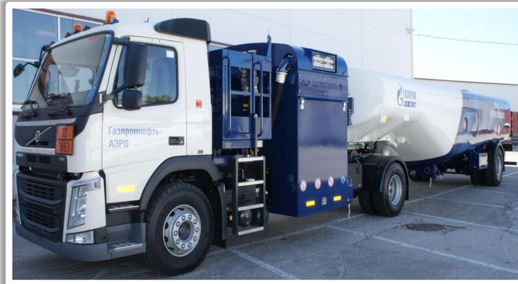
*20 декабря 2018 года АО «АТГС» совместно с АО «Нефтегазавтоматика» и ЗАО НПО «Авиатехнология» завершили работы по доработке 27 аэродромных топливозаправщиков в ООО «Газпромнефть-Аэро Шереметьево». Топливозаправщики были оснащены САУ с интегрированной измерительной системой автоматизированного модуля коммерческого учета авиатоплива.*
