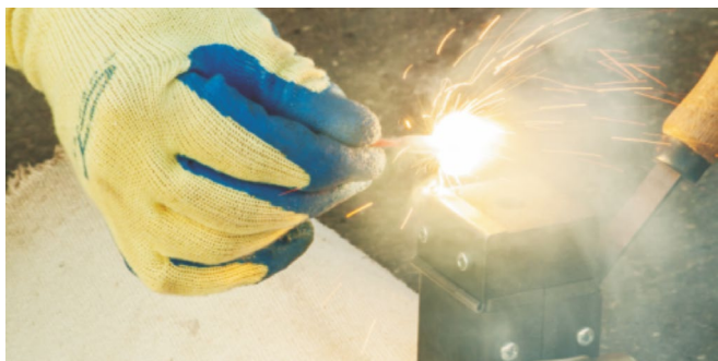
Процесс поджига термитной смеси термитной спичкой
