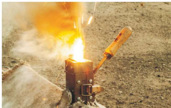
Процесс горения термитной смеси
