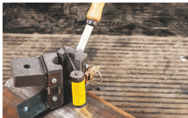
Закладка термокарандаша в многоразовую тигель-форму
