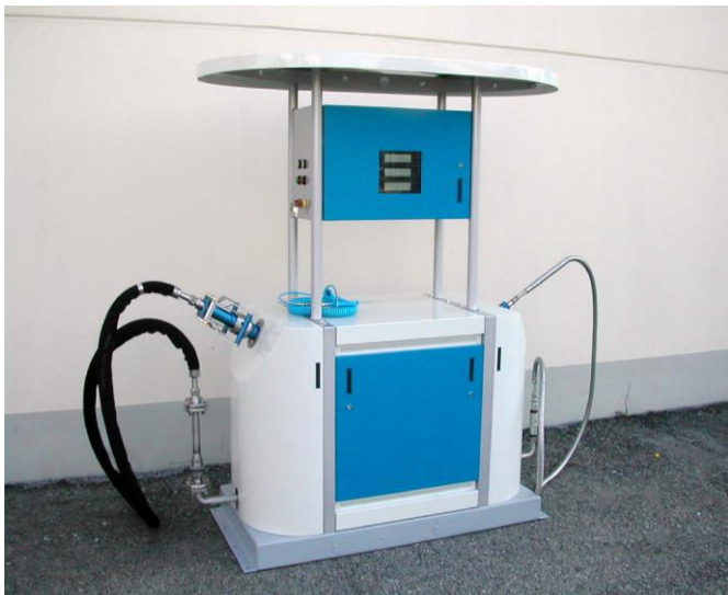
Заправочная колонка СПГ
